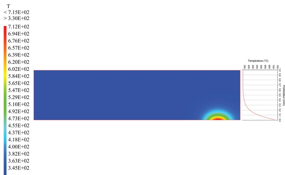
FIGURE 5.8. – Isovaleurs de température en °C au temps  $t=20$  ms, chauffe C13. A droite, dans l'encart : Température en fonction de la profondeur sur une coupe passant par la température maximale (position radiale  $r=R_{an}$ )
