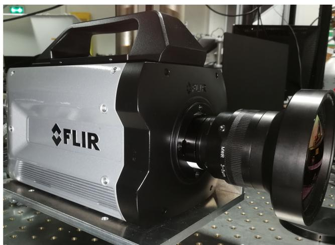
FIGURE 2.15. – Caméra FLIR avec la bague allonge 0,75 pouce et l'objectif de focale 100 mm
