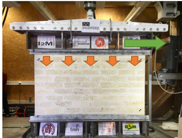
Mur en pierre et mortier de chaux dans un banc de cisaillement, I2M-Bordeaux / AIA Ingénierie
