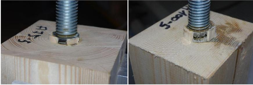
FIG. C.3 – Faciès de rupture des assemblages de grandes dimensions
