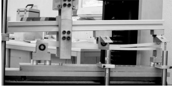
FIG. 3.33 – Dispositif expérimental pour les essais MMB [105]
