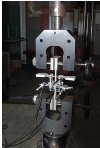
FIG. 2.7 – Caractérisation mécanique des résines par extensométrie
