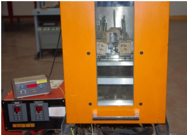
FIG. 2.34 – Chauffage des spécimens en étuve
