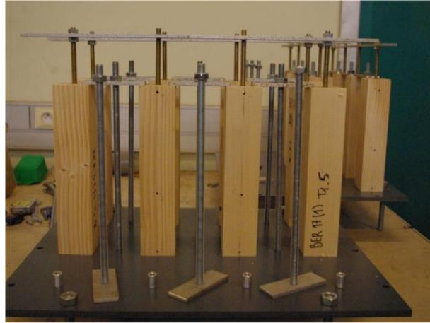
FIG. 2.18 – Fabrication des éprouvettes pour les essais en configuration pull-pull
