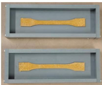
FIG. 2.4 – Coffrage pour la réalisation du moule
