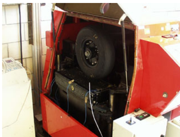
FIGURE 1.26: Essai d'orniérage (base documentaire IFSTTAR/MAST/MIT)
