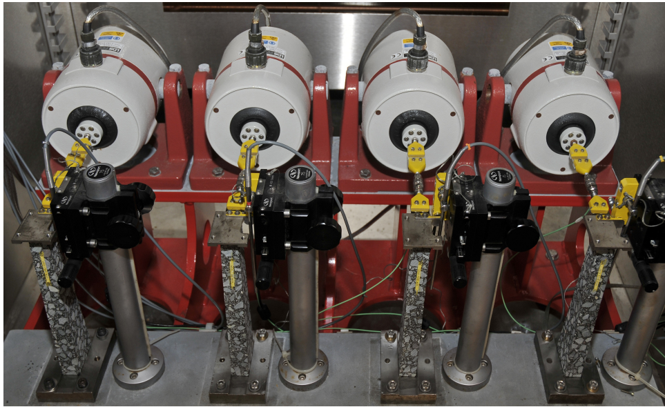
FIGURE 1.32: Essai de module complexe et de fatigue (base documentaire IFST-TAR/MAST/MIT)
