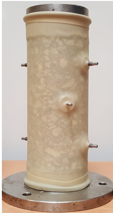
FIGURE 2.19: Epreuve avec membrane
