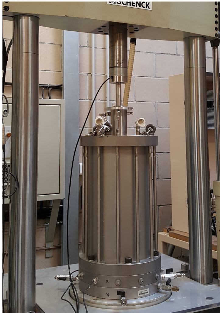
FIGURE 2.21: Cellule installée sous la presse
