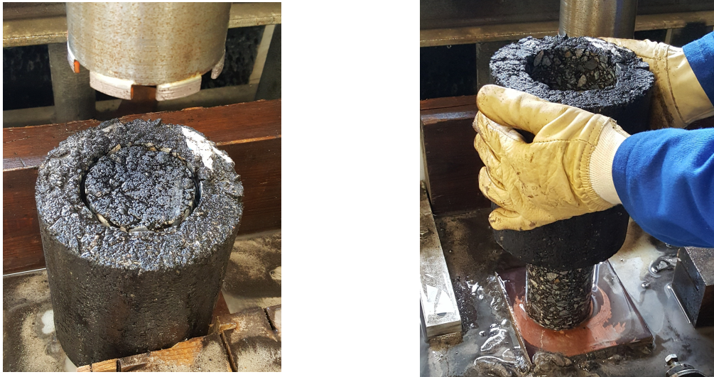
FIGURE 2.10: Carottage d'une éprouvette compactée à la PCG
