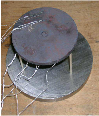
FIG. 1.64: Photo du montage pour l'essai OVEN-TEST et l'instrumentation en thermocouples
