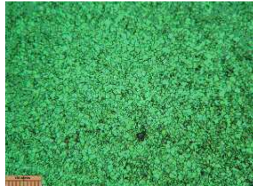
FIG. 2.72: Microstructure obtenue après traitement à 1000°C pendant 10 heures
