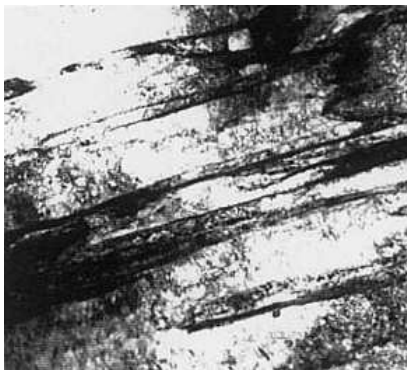
FIG. 2.13: Martensite en latte obtenue après une trempe à 1050°C sur un 9Cr1MoVNb, d'après [HLP01]
