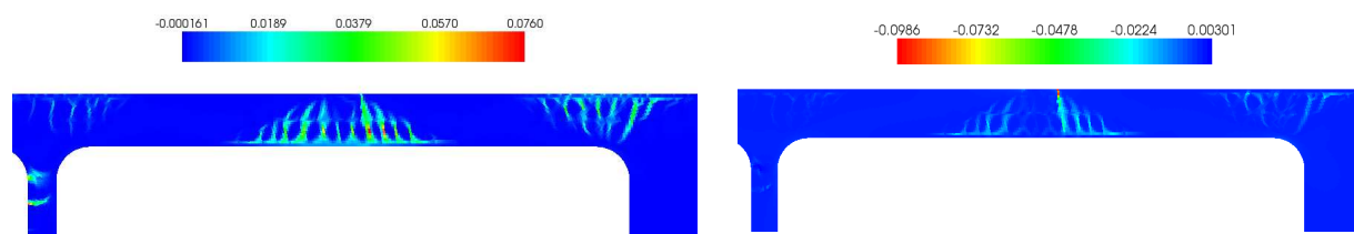
FIG. 4.71 – Cartographie d'endommagement obtenue pour un déplacement imposé égal à 100 mm.
