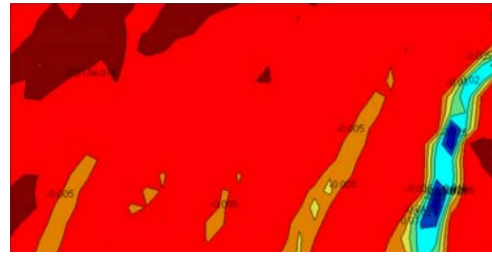
FIG. 4.75 – Mesures spectrométriques du champ des déformations principales - P = 10 MN.
