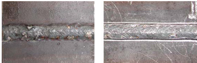
Figure I.42 : Comparaison d'un joint soudé brut de soudage (à gauche) et après traitement par martelage à haute fréquence (à droite) (Kudryavtsev et al. , 2006).
