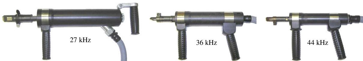
Figure I.35 : Marteaus de différentes fréquences de transducteur (Statnikov et al. , 2004).
