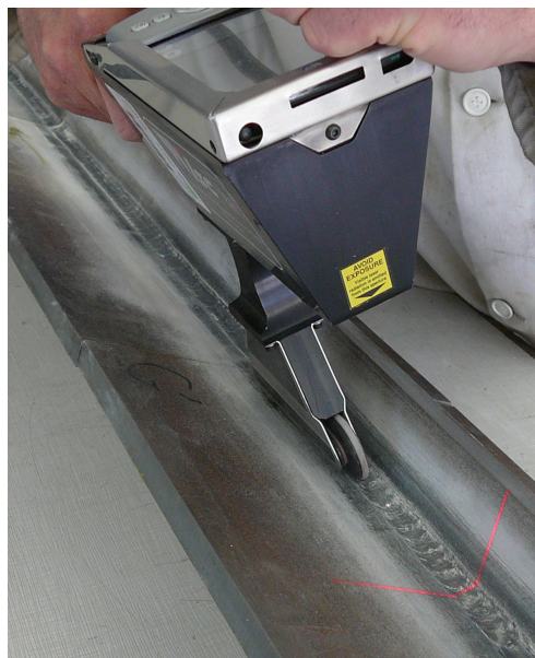
Figure II.2 : Analyse dimensionnelle par triangulation laser (procédé WISC).
