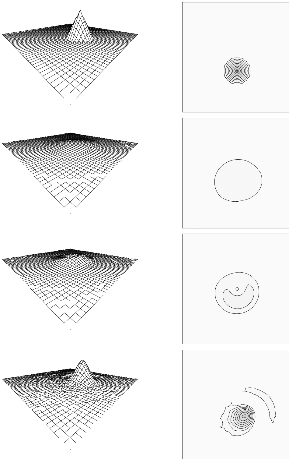
FIG. 1.2.2 – Rotation d'un cône : maillage 40 \times 40 quadrangles. solution exacte, opérateur TSCAL (explicite) avec les options SUPG-CC, SUPG et CENTREE. Isoconcentrations ( \Delta c = 0.1 ).
