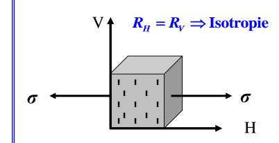
**Fissuration** ⇒ **Orthotropie** induite
