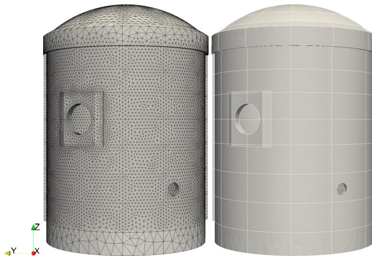
Figure 84 : Maillage du béton de la maquette Vercors et décomposition en zones.
