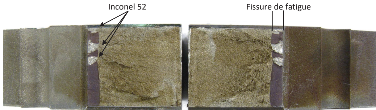
Figure IV-31 : Faciès de rupture d’une éprouvette CT12 multi-matériaux rompues à -125°C présentant des zones d’inconel 52 au niveau de la fissure de fatigue (726-K)
