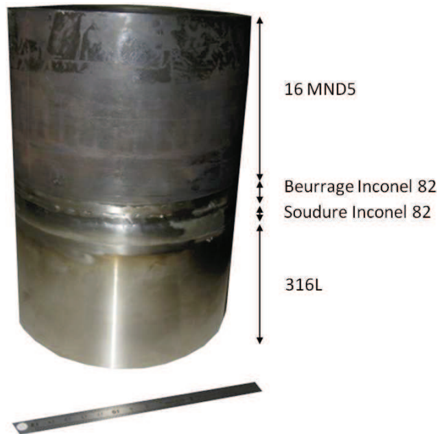
Figure III-1 : Maquette avec liaison bimétallique
