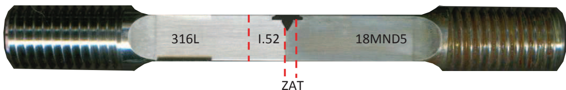
Figure IV-19 : Eprouvette SENT10 avec plan de rupture dans la ZAT du 18MND5
