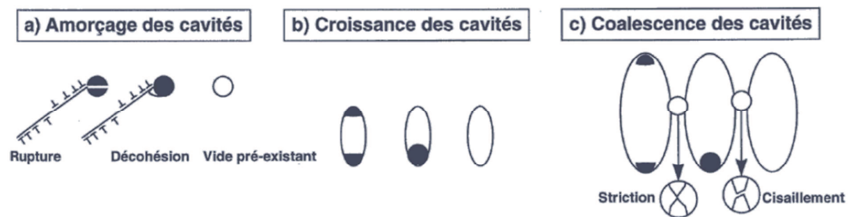
Figure A1-1 : Représentation schématique des trois stades de la déchirure ductile et de leurs différents mécanismes élémentaires [MIA 95]
