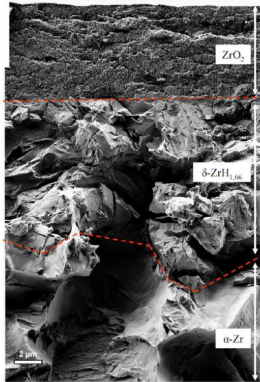
FIGURE 1.13 – Fractographie d’une couche d’oxyde formée sur un échantillon pré-hydruré de Zircaloy-4 à 360 °C en eau primaire (Bisor, 2010).
