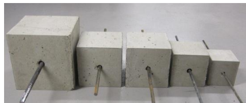
Figure 3-23 : Les différentes éprouvettes testées (de gauche à droite : HA16, HA12, L12, HA10, HA8)
