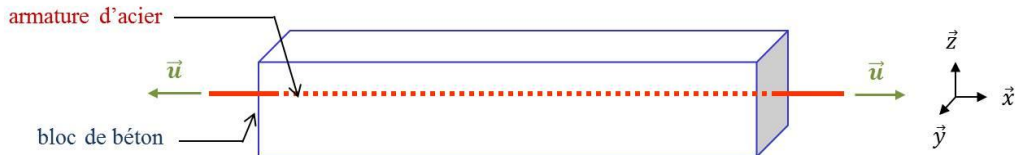
Figure 1-1 : Principe de l'essai de tirant
