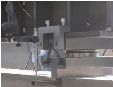
Figure 4-11 : Mesure du déplacement d'un appui
