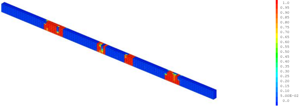
Figure 2-47 : Répartition de l'endommagement (scalaire D ) le long du tirant en fin de chargement (coupe dans le plan du renfort d'acier)
